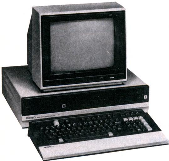
Deux configurations sont possibles : M 68 Mark 41 avec deux disquettes de 5,25 pouces de 1,2 million d'octets chacune; M 68 Mark 5 : deux disquettes de 8 pouces de 1,2 million chacune (extensible à quatre unités). En option, on peut adjoindre des disques durs Winchester de cinq pouces (8 millions d'octets) ou huit pouces (20 millions) voire une bande magnétique 1600 BPI (*bit per inch*).
